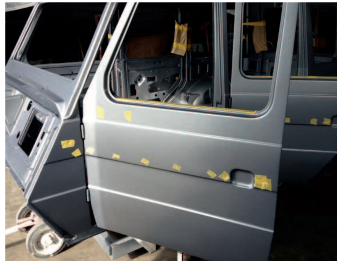
Alle gaten worden afgedicht om te voorkomen dat het tectyl van de binnenzijde van de deuren lekt op de laklaag.
