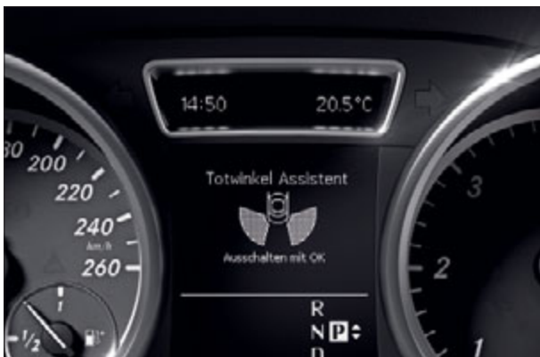
De actieve dodehoekassistent kan de bestuurder waarschuwen voor voertuigen in de dode hoek.
