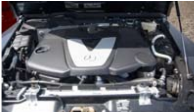
De moderne common-rail V6-diesel in de G 320 CDI weet met zijn 224 pk de gang heel aardig in de zware Benz te krijgen.
